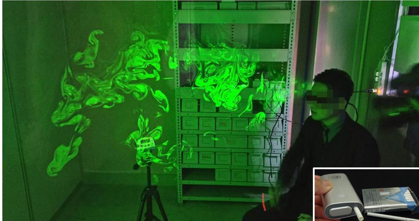
呼出される加熱式タバコ・glo™（グロー）のエアロゾル（二次元レーザーの照射により可視化）
